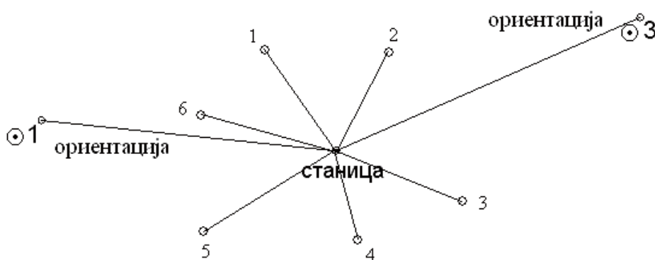
Сл. 69. Ориентирање на инструментот кон точка 1 и точка 3.
