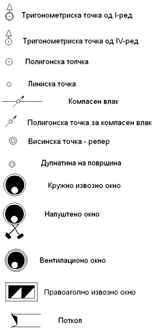
Сл.121. Топографски ознаки за геодетски точки и рударски простории на рударски план.
