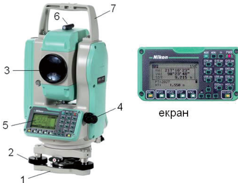
Сл.30. Електронски тахиметар (total station): 1. подножје, 2. положбен винт, 3. објектив, 4. оптички висок, 5. екран со тастатура, 6. оптички нишан, 7. рачка за носење.
